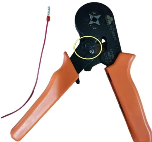
图 4.18 管形端子压线钳
