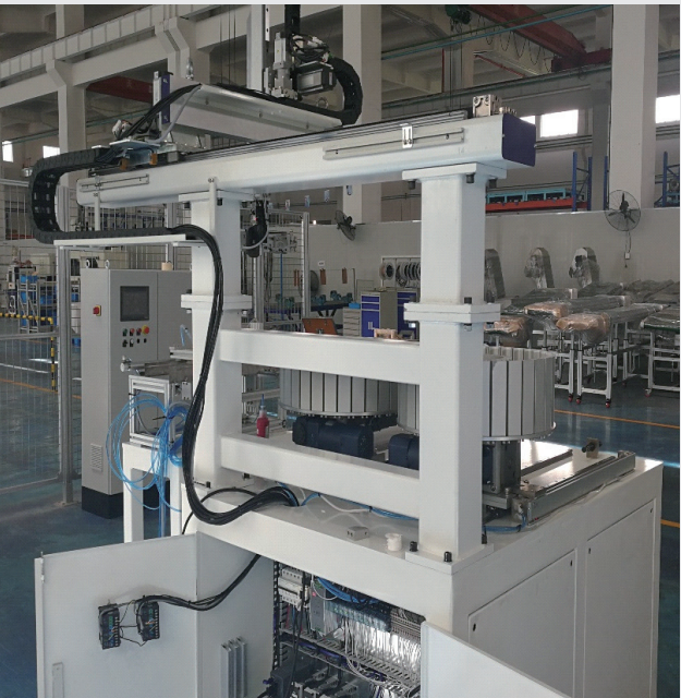
机床上下料机械手 (定位精度 0.05mm)
