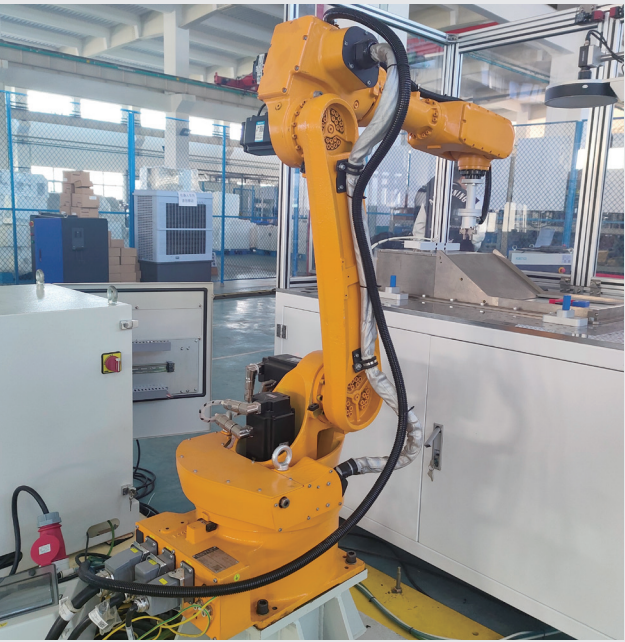
六轴通用机器人 (定位精度 0.03mm)
