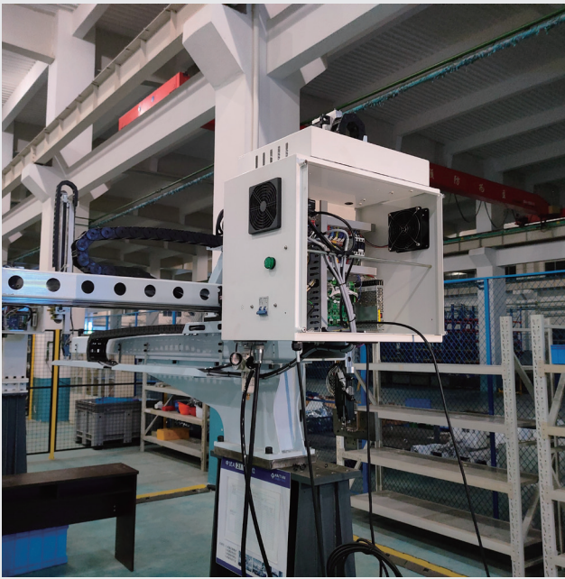
海天 V 系列桁架机械手 (机械手控制，定位精度 0.05mm)
